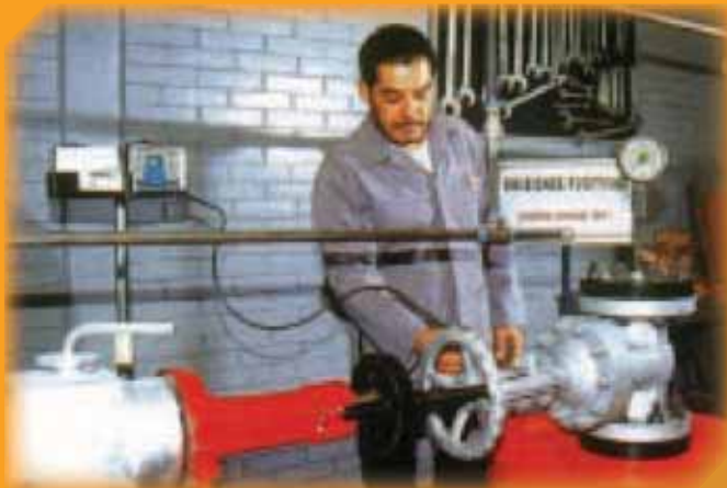
Pruebas de laboratorio, Medición de emisiones con gas Helio, pruebas de apertura y cierre de hasta 1000 ciclos.
